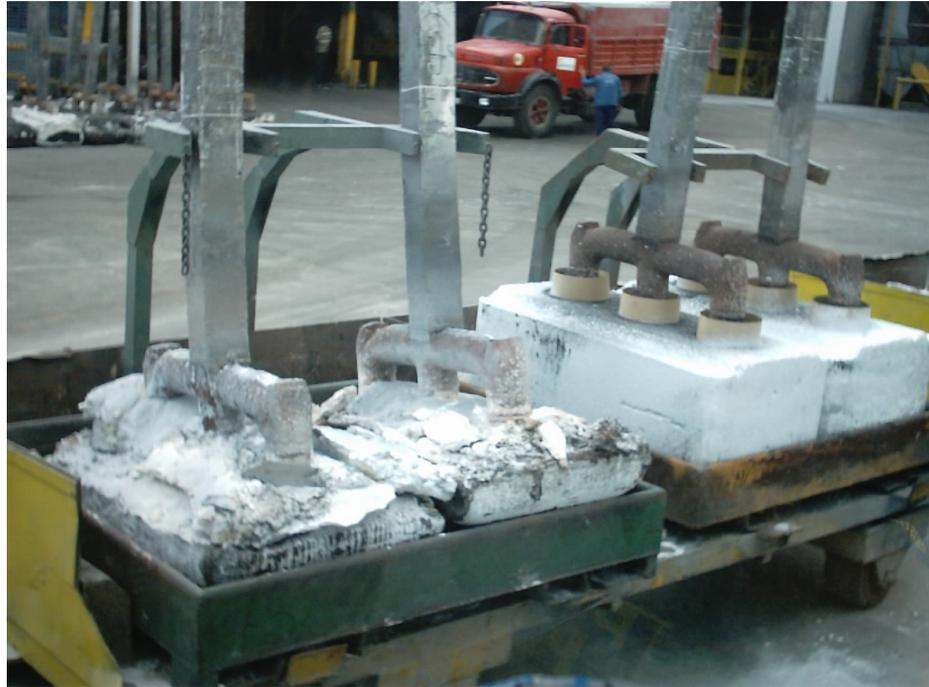
La corriente eléctrica (corriente continua) necesaria para la reducción de aluminio se introduce en la celda a través de los ánodos.
